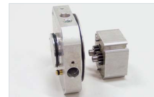
Pompy hydrauliczne stosowane w napędach serii tousek Swing wyróżniają się szczególnie cichą pracą.
